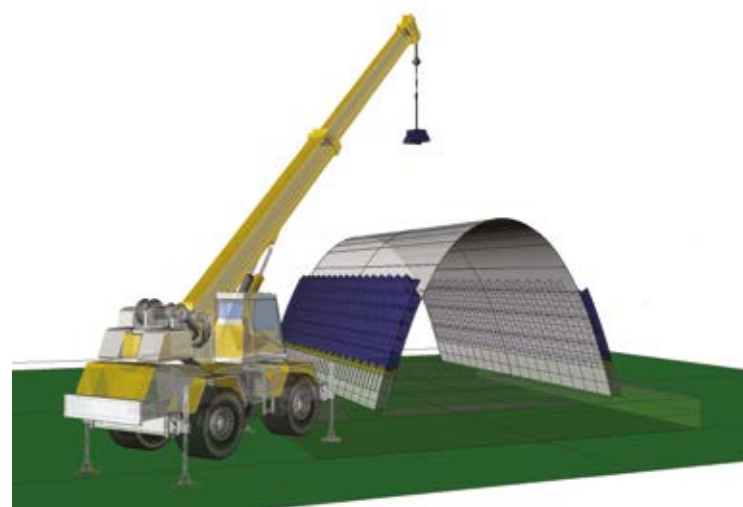
Fig. 8 Montaggio dell'arco catenario a giunti osteomorfi; Fig. 9 Armatura estradossata dell'arco per post-tensione di precompressione della struttura; Fig. 10-11 Esempificazione di montaggio.
