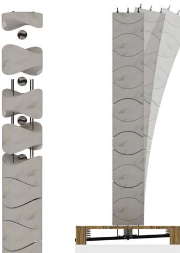
Figg. 12-13 Comportamento "flessibile" della Colonna Osteomorfa; Figg. 14-15 Realizzazione della Colonna Osteomorfa.
