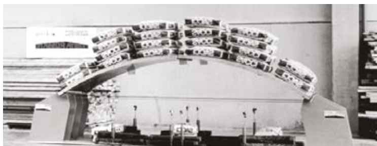
Fig. 8 Prova di carico della volta di copertura della sede IMM Carrara
