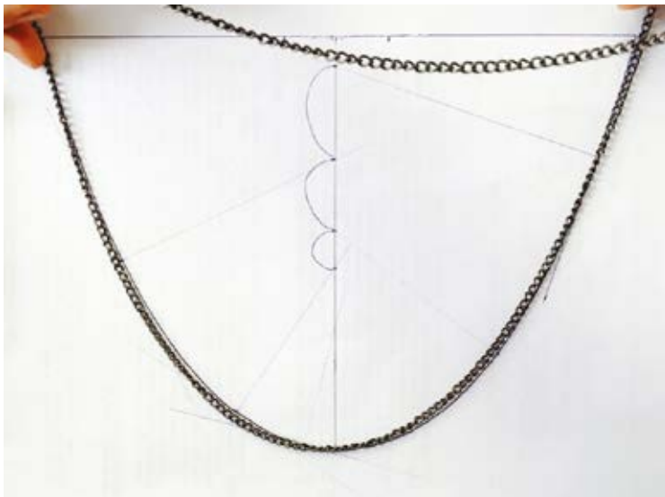
Figg. 5-6-7 Fasi di montaggio dell'arco catenario precompresso a giunti osteomorfi.
