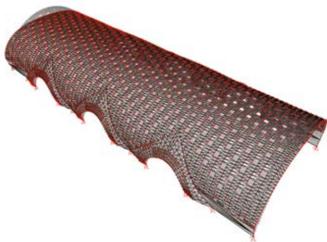
2. Configurazione deformata _ carichi verticali
